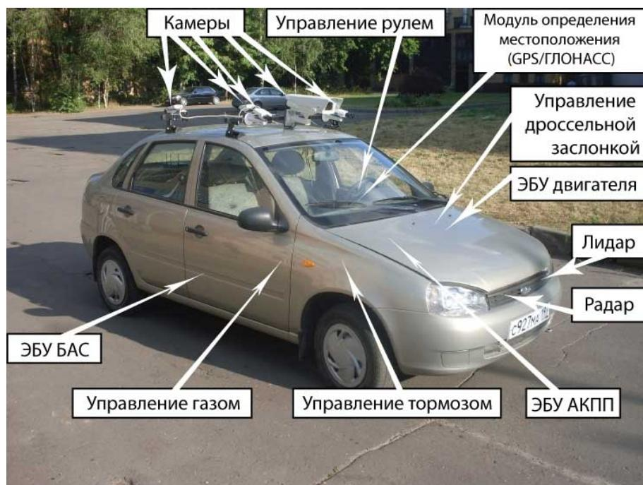
Рисунок 1.9 – Система «технического зрения» легкового автомобиля
