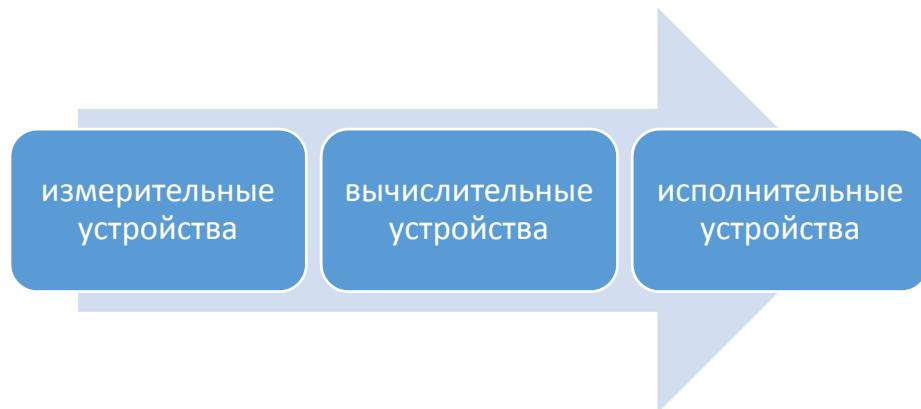
Рисунок 1.15 – Структура системы управления беспилотным АТС
