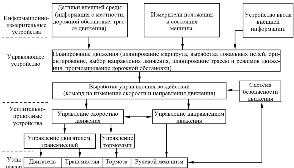
Рисунок 1.16 - Функциональная схема бортовой системы управления
