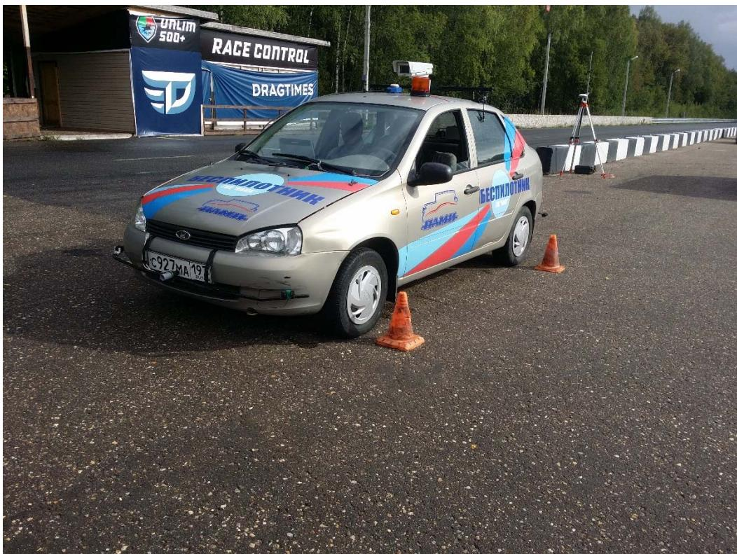
Рисунок 4.5 – Внешний вид беспилотного АТС на базе «LADA-Калина» с подключенной системой ADMA-G и развернутой базовой станцией
