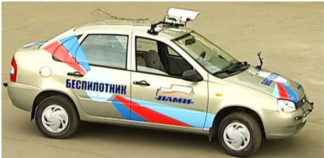
Рисунок 1.8 – Макетный образец беспилотного АТС на базе легкового автомобиля
