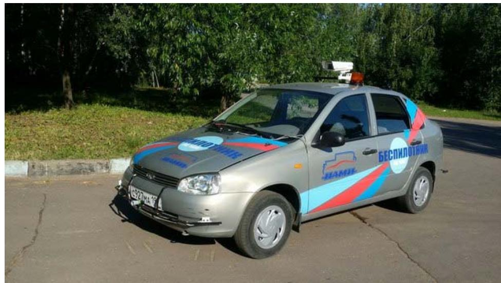
Рисунок 4.1 – Беспилотное АТС на базе «LADA-Калина» с механической трансмиссией
