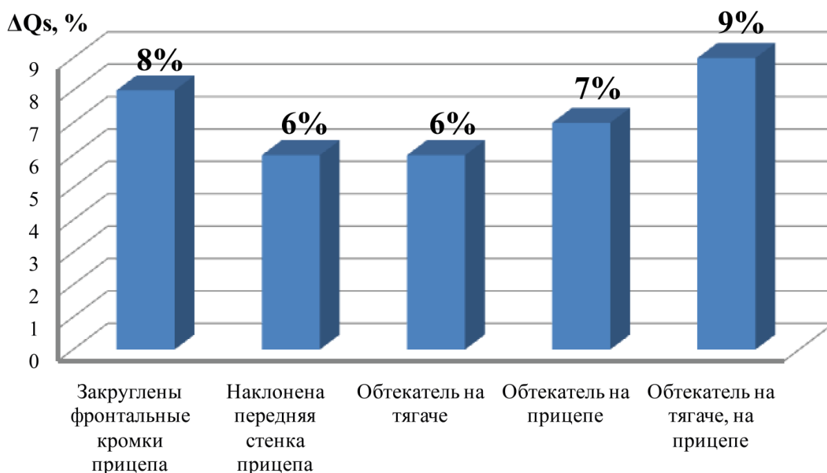
Рисунок 7 – Достижимое снижение расхода топлива легкового автопоезда с высоким прицепом при движении по бетонному шоссе со скоростью 70 км/ч за счет реализации разработанных мероприятий по улучшению обтекаемости прицепа
