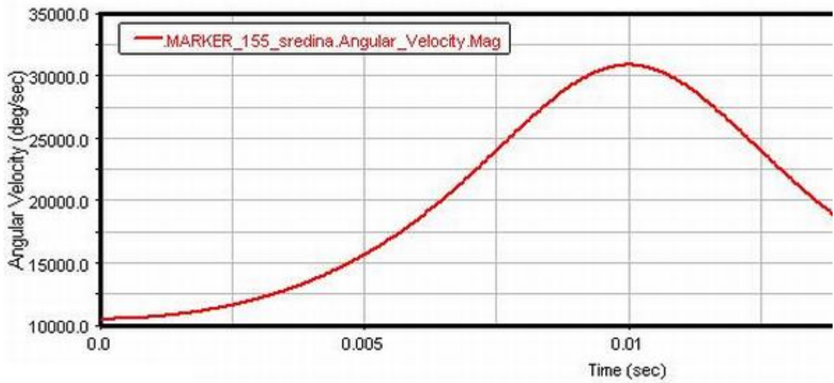
Рисунок 6 – Угловое ускорение лопасти механизма роторно-лопастного двигателя А. С. Лысенко, градус/с (рисунок предоставлен А. С. Лысенко)
