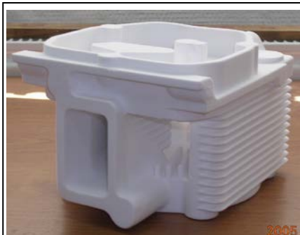
Полистирольная модель и отливка головки цилиндра ДВС
