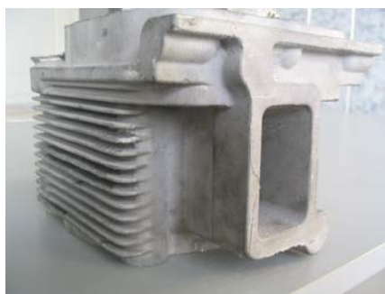
Полистирольная модель и отливка головки цилиндра ДВС
