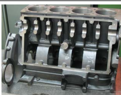
Quick-cast модель и отливка блока цилиндров (чугун)
