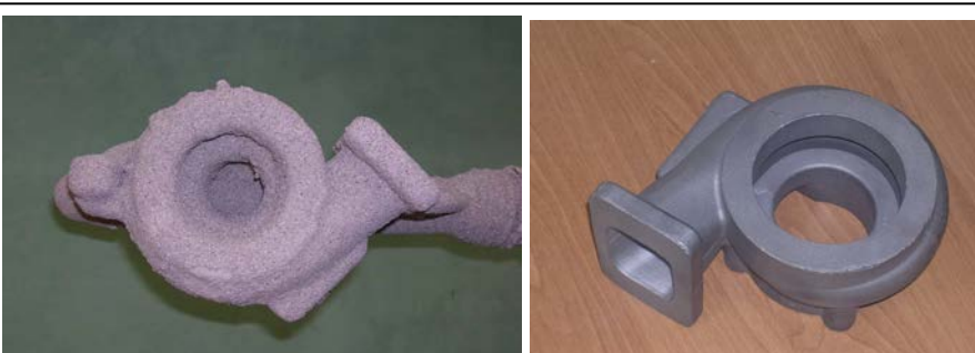
Оболочковая форма и отливка корпуса турбины (чугун), полученные по восковой синтез-модели
