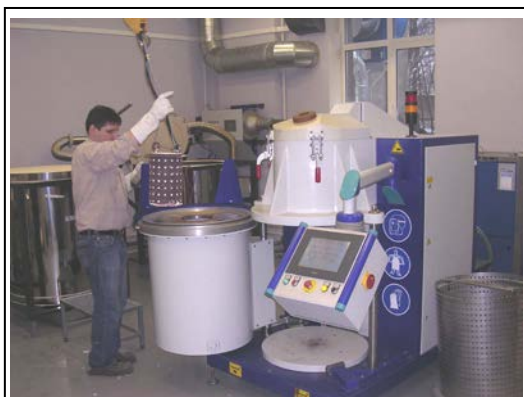
Вакуумная машина MPA 1000 (MTT Technologies) с объемом тигля 10 л для литья цветных металлов
