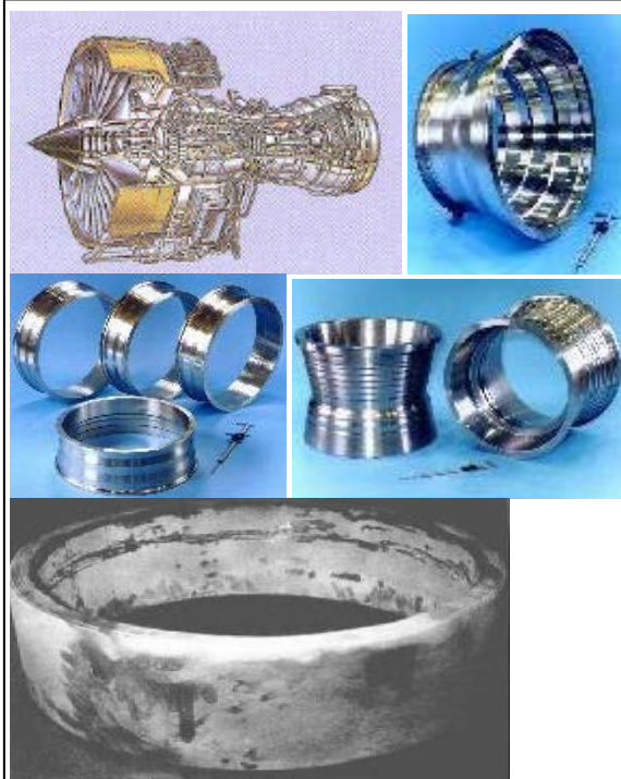
Примеры деталей авиадвигателя, полученные с использованием технологии « Spray forming »
