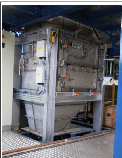
Установка « Spray forming » Оксфордского университета, (до 80 кг по Al )
