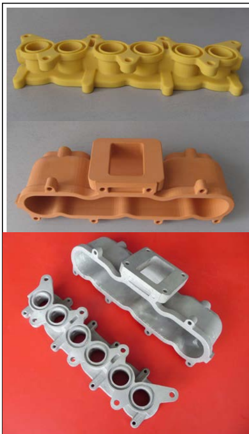
Модели Envisiontec и отливки деталей ДВС, алюминий
