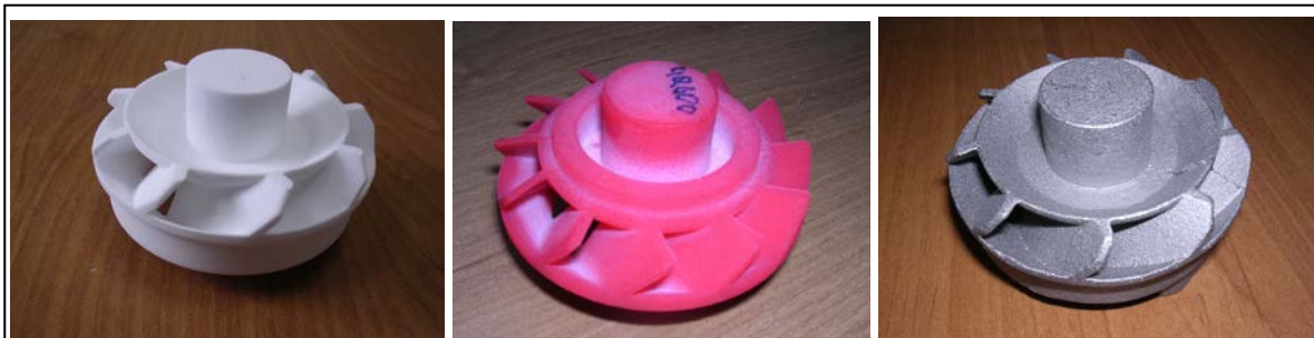
Полистирольная модель (после выращивания и инфильтрации) и отливка, чугун
