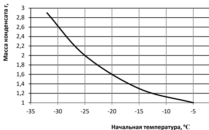
Рисунок 5 – Зависимость массы водного конденсата, образующегося на поверхности цилиндра, от начальной температуры прогрева двигателя
