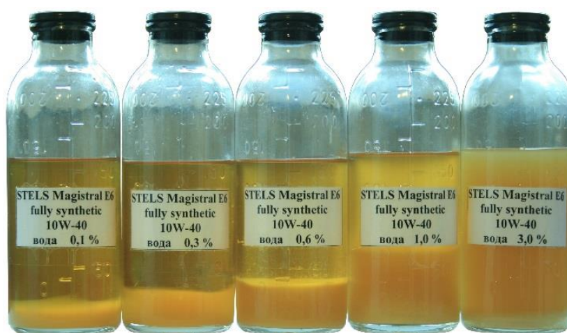
Рисунок 9 – Образование осадка в обводнённом товарном масле
