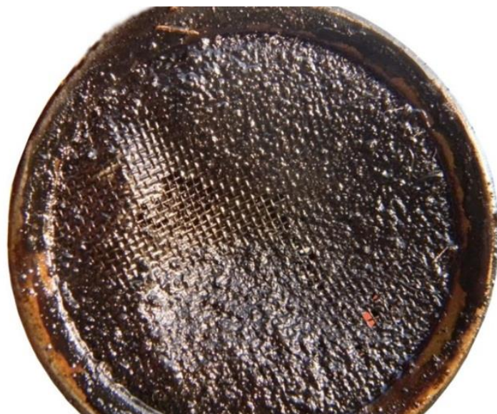
Рисунок 1 – Типичные низкотемпературные отложения на сетке маслоприёмника
