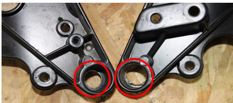
Рисунок 11 – Разрушенные места крепления передней части рамы
