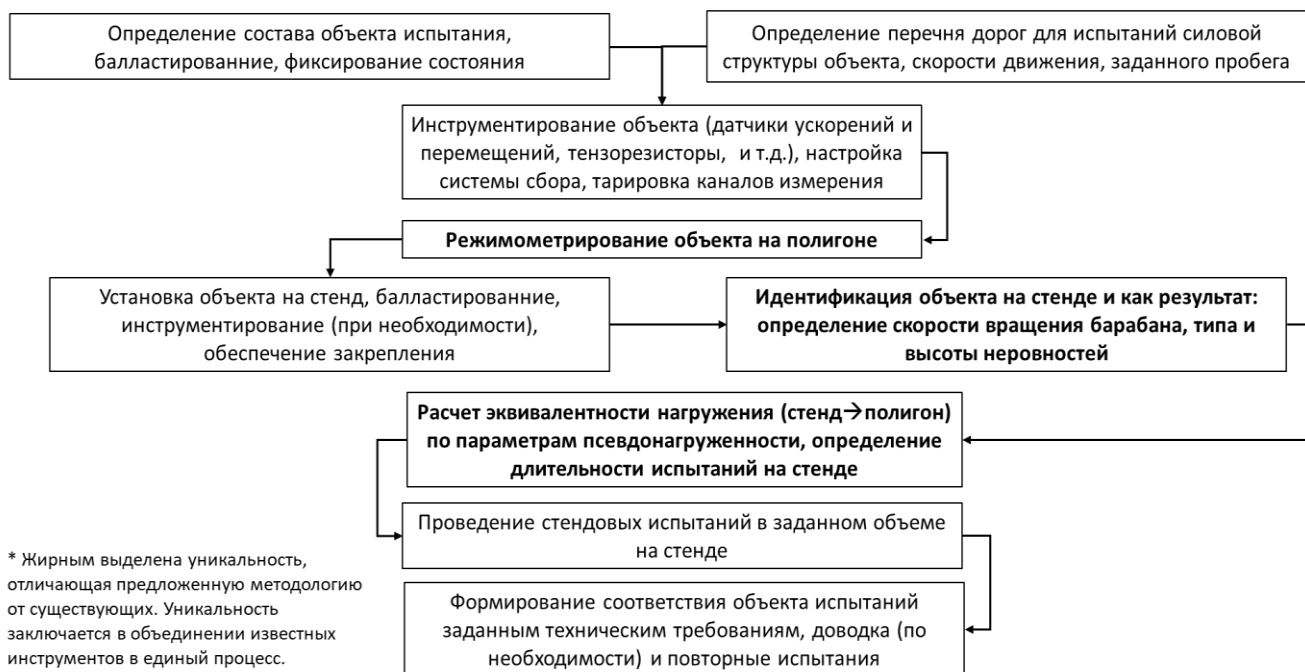
Рисунок 10 – Алгоритм выполнения испытаний несущей конструкции мототехники на стэнде с беговыми барабанами на усталостную долговечность согласно разработанной методике
