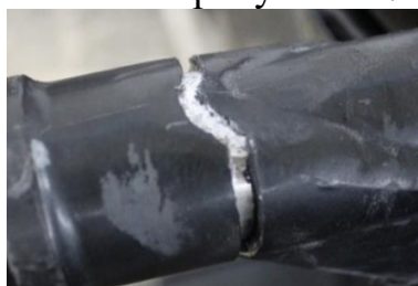
Рисунок 14 – Место разрушения рамы бокового прицепа
