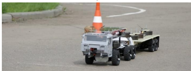
Рисунок 14 – Определение тягово-скоростных свойств физической модели
