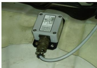
Рисунок 6 - Датчик угловых скоростей и линейных ускорений TANS
