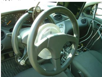
Рисунок 4 - Рулевое измерительное колесо MSW для измерения угла, скорости и момента поворота руля
