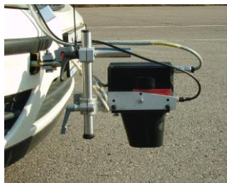
Рисунок 5 - Бесконтактный оптический датчик CORREVIT S-CE w/Gуго для измерения продольной и боковой линейных и угловой скорости автомобиля
