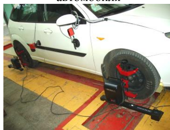
Рисунок 7 - Стенд для измерения и регулировки углов установки колес
