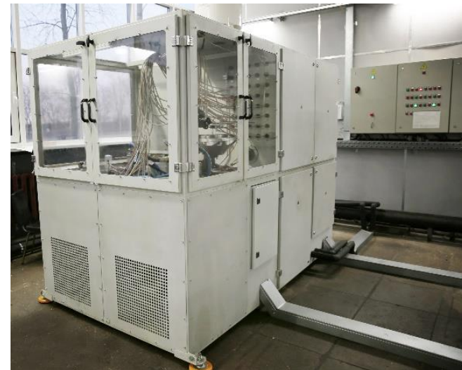
Стенд гидравлических испытаний ЭГБУ
