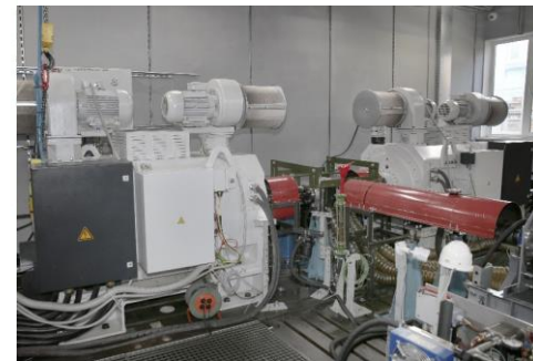
Специальный стенд испытаний автоматических трансмиссий автомобилей мощностью до 800кВт (FEV)
