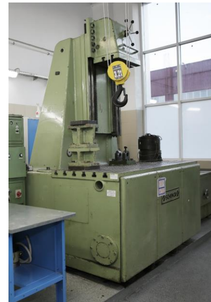
Стенд Schenk PVTN для статических испытаний образцов, узлов и деталей транспортных средств
