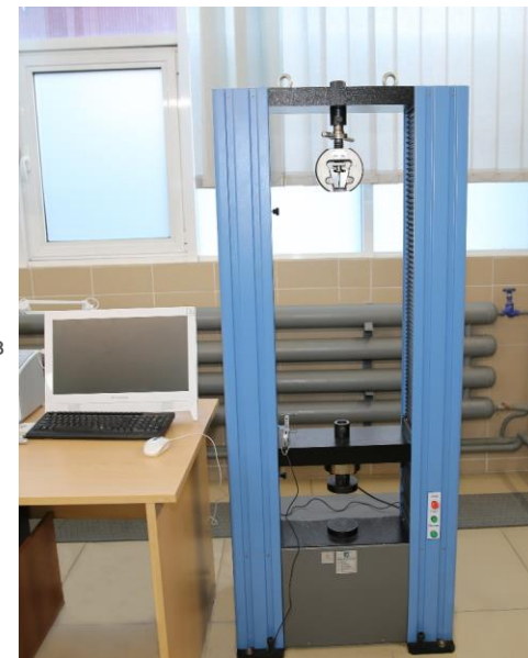
Универсальная испытательная разрывная машина РЭМ-50-A-2 до 5 т
