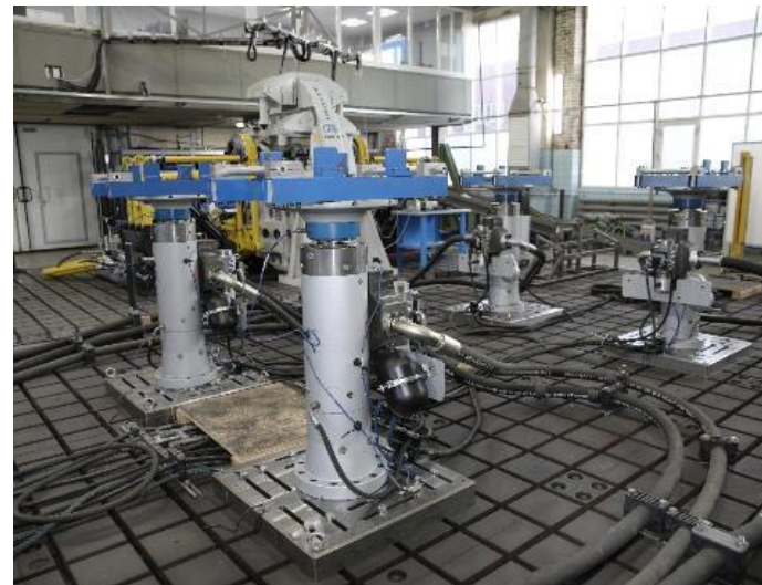
Стенд гидропультаторный «Имитатор дороги» (4 гидроцилиндра)
