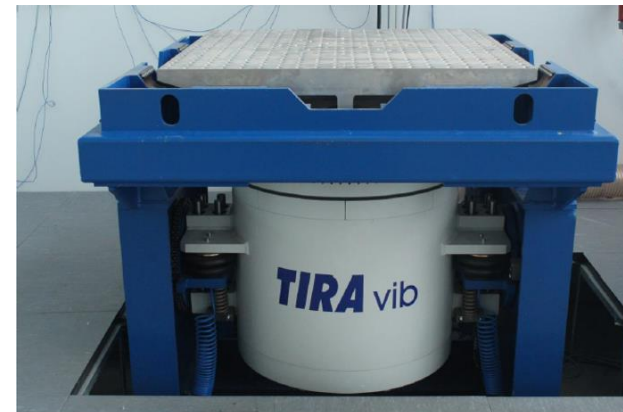
Электродинамический вибростенд Tira TV 59335/AIT440, Германия
