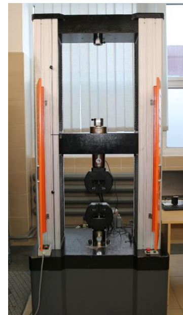
Универсальная испытательная разрывная машина WDW 300 до 30 т.
