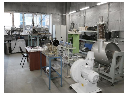
Стенды для испытаний топливных, воздушных, масляных фильтров
