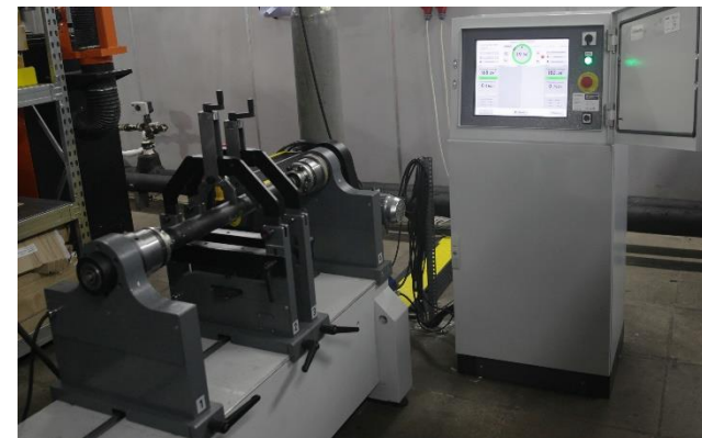
Горизонтальный дорезонансный балансировочный станок с жесткими опорами для карданных валов «ДБР КАРДАН -600»
