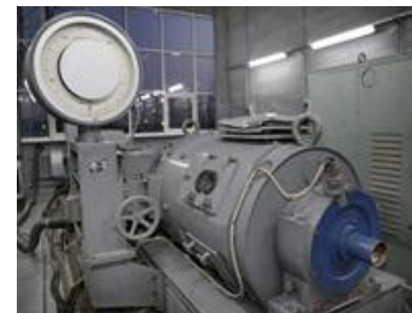
Динамометрическая машина Mez Vsetin DS 1146-4K/V
