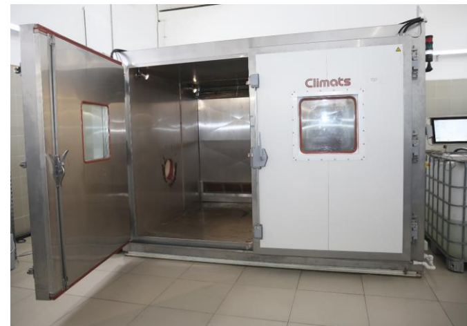
Климатическая камера (с системой управления на базе ПО "Spirale-3")
