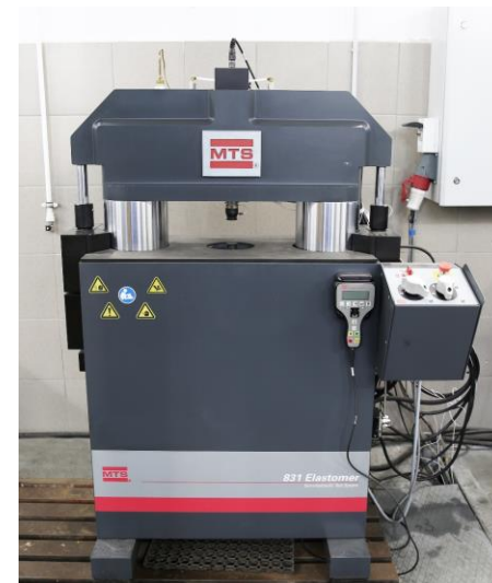
Стенд для испытания эластомеров MTS Automated 831.50 Elastomer Test System
